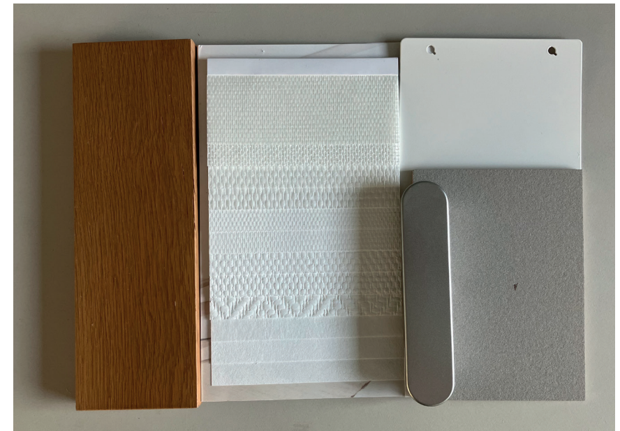
Farb-Material-Werkzeugkasten: Holz materialsichtig, Gewebetapeten, Sockelblech, Chromstahl
